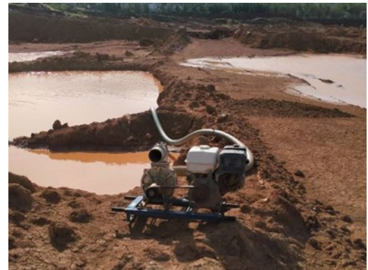
รูปที่ 2-18 ปั๊มน้ำบริเวณบ่อรับน้ำ (Sump) ภายในพื้นที่โครงการฯ
